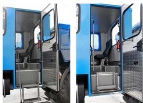
Обниженный вход в совокупности с **откидной двухступенчатой лестницей** обеспечивают максимальное сочетание удобства посадки пассажиров и компактность в транспортном положении. Возможен вариант исполнения с **трехступенчатой откидной лестницей**. Минимальное расстояние от земли до нижней ступеньки достигается увеличенной длиной лестницы. Ступеньки лестницы выполнены из листа рифленого алюминия. Лестница оборудована поручнем. Для освещения ступенек лестницы в темное время суток входная группа
