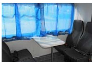
Все окна изготовлены с применением **двойного герметичного стеклопакета из травмобезопасного стекла** с уплотнителем толщиной 40-60 мм.
