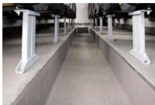
Пол вахтового автобуса изготавливается из водостойкой бакелизированной фанеры с утеплением высокоплотным пенополистиролом толщиной 30 мм и **высокопрочным многослойным полимерным покрытием на текстильной основе** технического назначения с *противоскользким эффектом*. Такая
