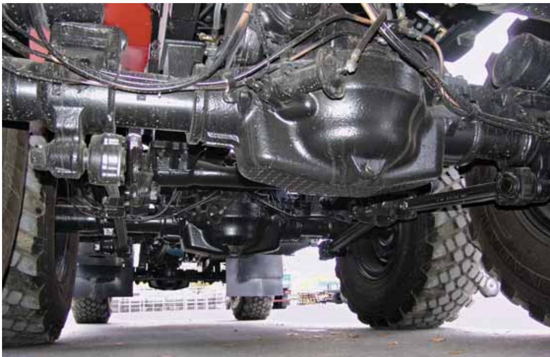
На задние мосты в базе установлена межколесная блокировка
