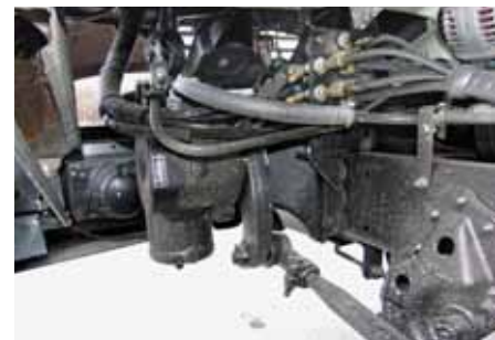
▲ Рулевой механизм интегрального типа RBL
