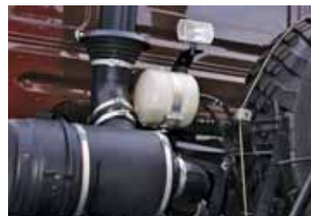
Расширительный бачок переехал за заднюю стенку кабины
