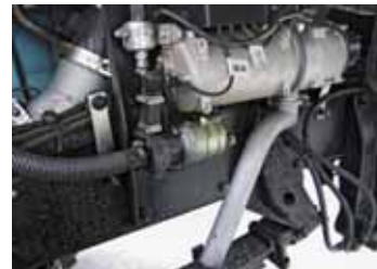
▼ Предпусковой подогреватель 14ТС-20 (Теплостар) производства самарского ООО «АДВЕРС»
