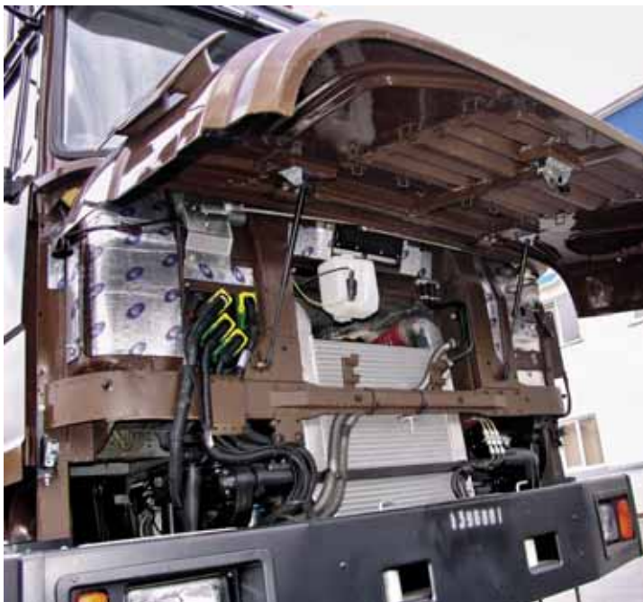
Масляный щуп за снопом трубок не сразу и разглядишь
