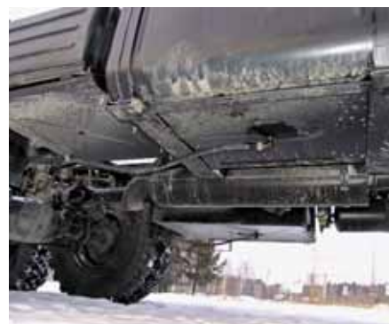
Расширительный бачок переехал за заднюю стенку кабины
