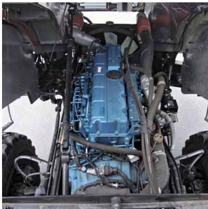
Под капотом модернизированных Уралов теперь рядная «шестерка» ЯМЗ
