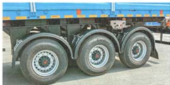
Трех осей SAF с односкатными шинами вполне достаточно для восприятия большей части полной массы полуприцепа
