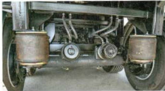
Одно из достоинств пневмоподвески - равномерность загрузки осей, что очень важно для 44-тонного полуприцепа
