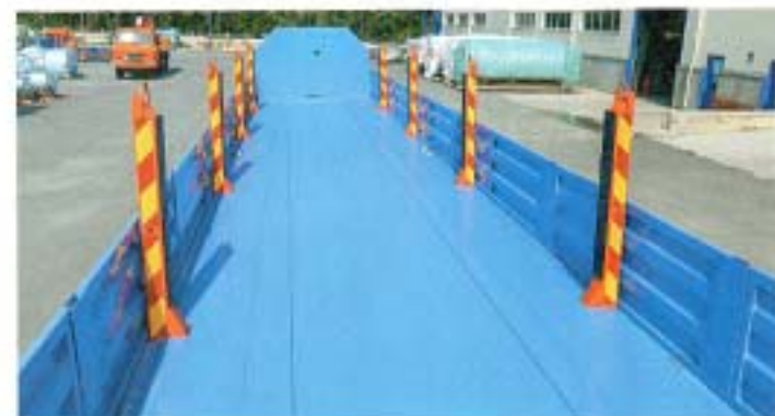
В сдвинутом состоянии коники расположены внутри кузова и защищают борта от повреждений тяжелым грузом
