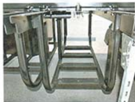
Съемные борта и коники можно сложить в специальную корзину
