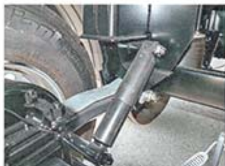
Переднюю ось можно поднять над дорогой, подав воздух в пневмокамеры
