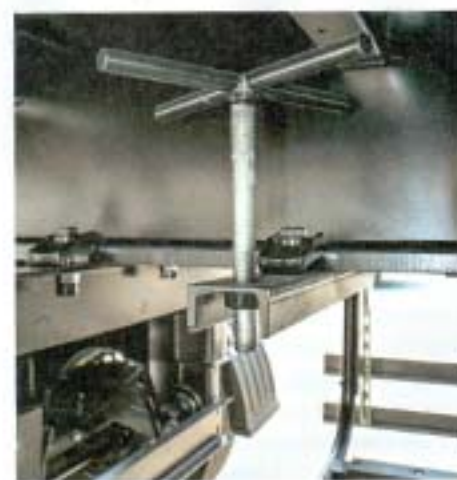
Под платформой съемные борта фиксируют специальным зажимом
