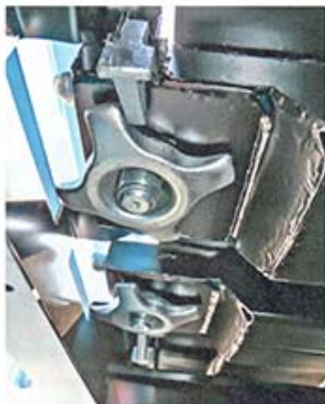
Замки-твистлоки притягивают контейнер к платформе мощными гайками
